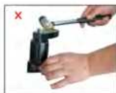
不正確拆壓板
